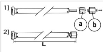
2] Misurare la lunghezza (L) tra il bordo interno della testa della motorizzazione e l'estremità della ruota.
