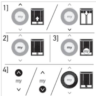
pulsante **My**. Il prodotto motorizzato si sposta automaticamente prima nel finecorsa inferiore, poi nella posizione My.
