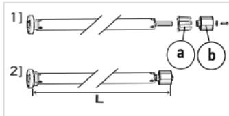
2] Mesurer la longueur (L) entre le bord intérieur de la tête de la motorisation et l'extrémité de la roue.
